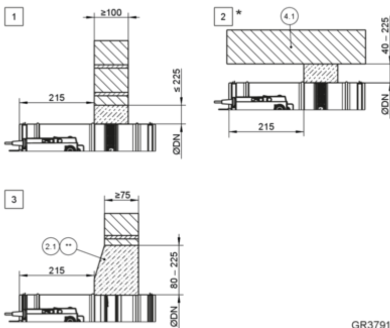
Rys. 32: Montaż z wykorzystaniem zaprawy w ścianach sztywnych
