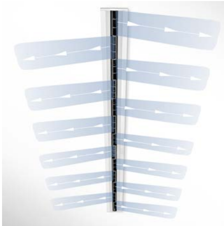
Poziomy, naprzemienny wypływ powietrza
