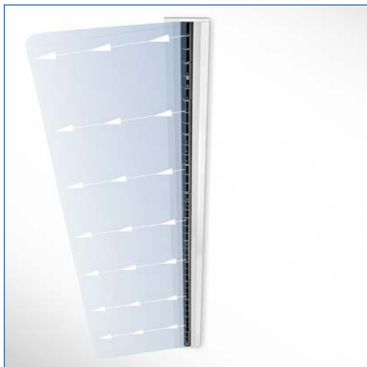
Poziomy, jednostronny wypływ powietrza w prawo
