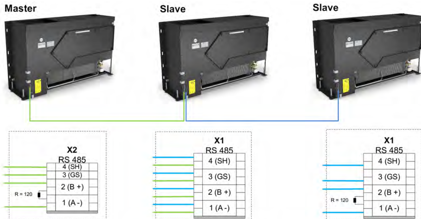
Rys. 22: FSL CONTROL III komunikacja 3 jednostek
