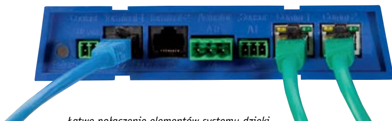
Łatwe połączenie elementów systemu dzięki standardowym sieciowym kablom komunikacyjnym
